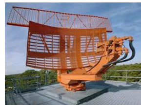
Primär- und Sekundär-Radar (unten und oben)
